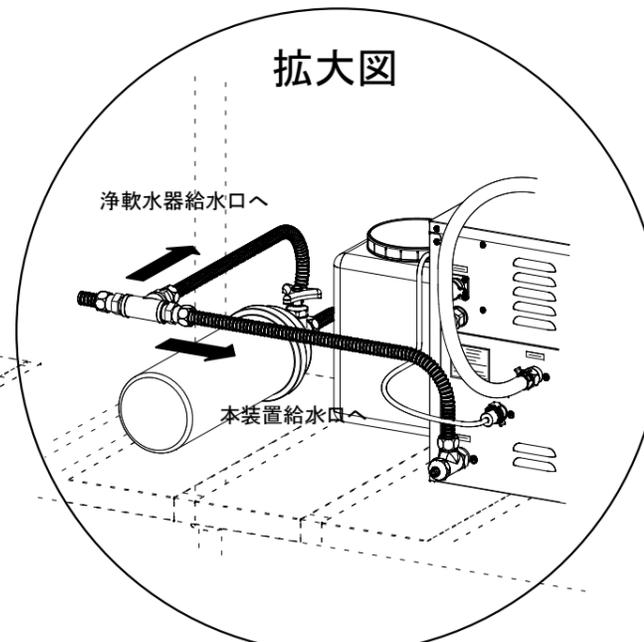
(注意) 給水はチーズ配管で分岐させ、浄軟水器の給水口と本装置の給水口に接続してください。
